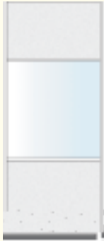
Verglasung ab Brüstungshöhe 1000 mm
